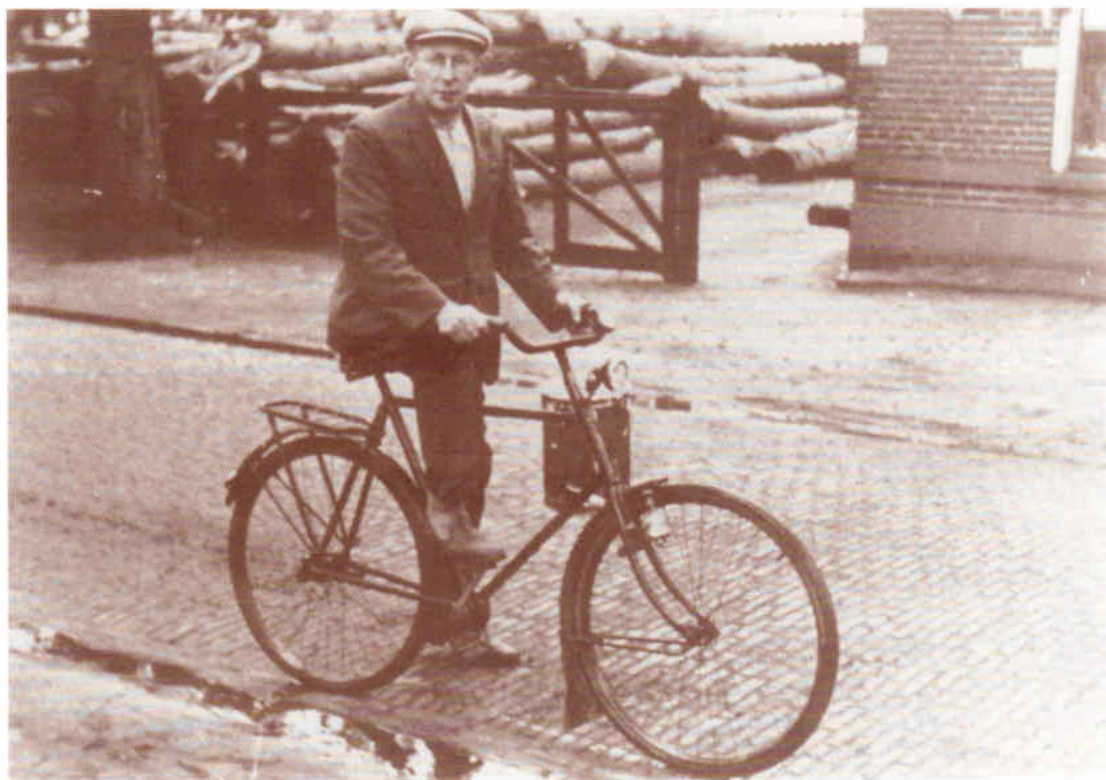
Let op: deze fiets heeft geen ketting. De trapbeweging wordt door een cardanas overgebracht op het achterwiel.
