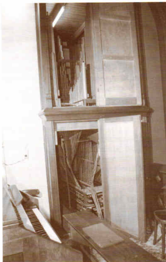
Duidelijk zijn de buizen te zien van de pneumatische overdracht.
